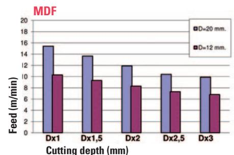
**SOLID CARBIDE SPIRAL CUTTERS ROUGHING STYLE Z=3, Klein<sup>DIA</sup> COATED**
